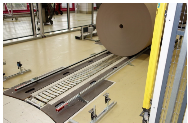
Abb. 13 - 16: SLM - Applikations und Sensor-Anordnungsbeispiele
