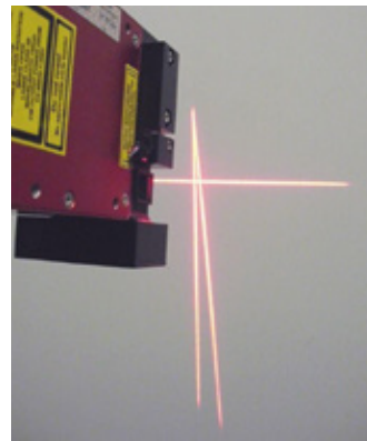
Bild 1: Der Sensor ist verkippt
