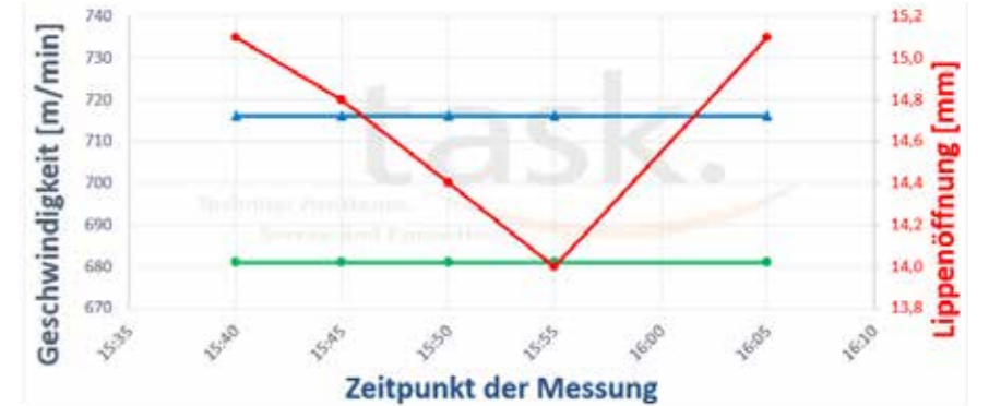
Abb. 6: Strahlgeschwindigkeiten (blau und grün) bei verschiedenen Lippenöffnungen (rot): trotz Veränderung gleich geblieben. Sie dürfen bei verschiedenen Öffnungen nicht variieren.
