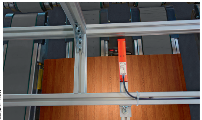
Das berührungslose Stückgut-Längen-Messsystem SLM von Elovis meistert Messaufgaben bei maximaler Produktionsgeschwindigkeit mit hoher Präzision
