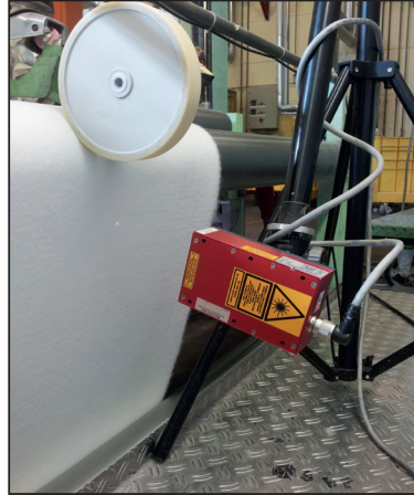
Abb. 4: Mobile Kalibriermessung von Vlies vor Aufrollung
