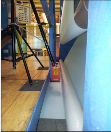
Abb. 3: Mobile Kalibriermessung von Vlies am Wickler
